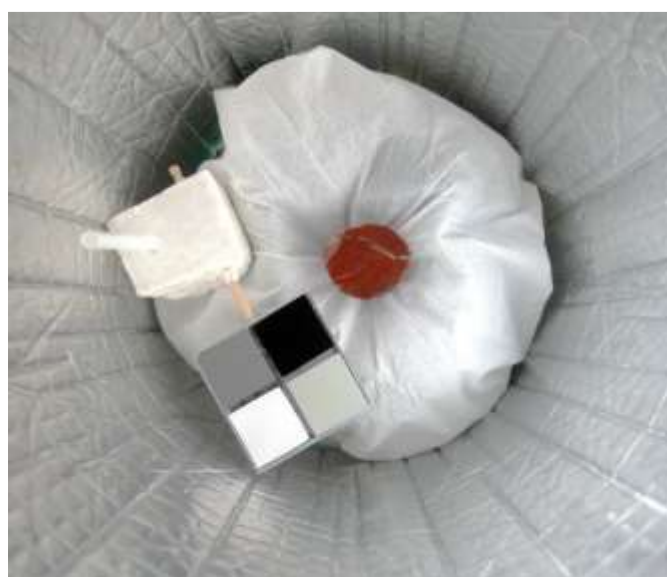
図2. 礫表面色を計測する際の撮影システム
